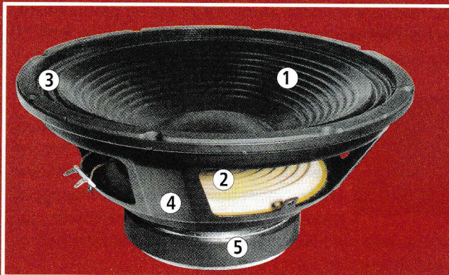
Vue du haut-parleur grave de 31 cm. 1 – Membrane en pulpe de cellulose traitée avec du latex de Butyl. 2 – Bobine mobile de 5 cm de diamètre sur support aluminium. 3 – Suspension petits plis en tissu traité. 4 – Saladier en acier déployé avec fort nervurage. 5 – Aimant ferrite de 25 mm, avec plaques de champ de 8 cm, densité de flux de 12 000 Gauss.
